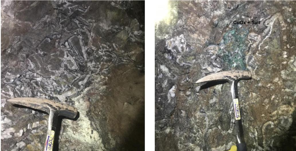
**Fotografía 3.** Muestra textura brechosa de la estructura mineralizada principal, en la que se pueden apreciar cúmulos aislados con mineralización de oxidados de cobre y calcosina. También se aprecia bandas finas grises.
